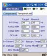
Sprawdź tryb pracy sprężarki
